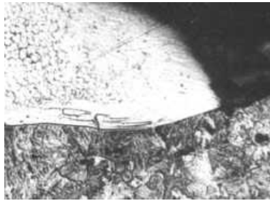
Рис. 5. Мікроструктура валика самофлюсного стопу ПГ-12Н-01, натопленого на крицю 08кп лазером ЛТН-103 ( P = 140 Вт; V = 100 мм/хв.); \times 400 .
