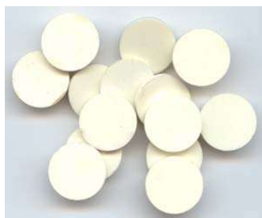
Рис. 1. Исходные образцы пиролитического ВН (диаметр 15 мм, толщина 2 мм), вырезанные из пластин массивного материала.
