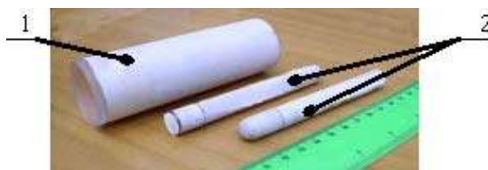
Рис. 7. Образцы сапфирокерамических и керамических изделий, полученные давлением через палладиевую прокладку с использованием платинового нанопокртия: 1 — сапфирокерамическое окно; 2 — кислородные датчики.
