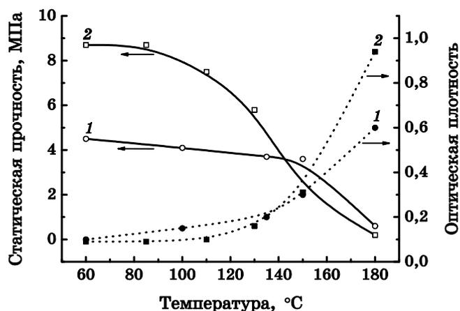
**Рис. 3.** Зависимость статической прочности и оптической плотности кальцийфосфатных цементов на основе 17% геля ГА и порошка ГА, обработанного 5% раствором полимера в зависимости от температуры прогрева: 1 — ГА/Na-КМЦ; 2 — ГА/ПВС.
