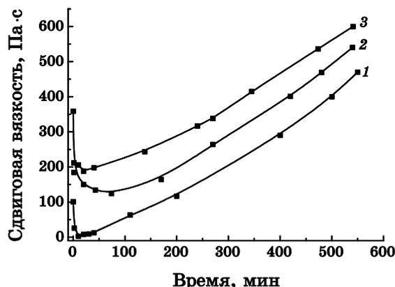
**Рис. 2.** Зависимость вязкости твердеющей композиции гель ГА/порошок ГА ( $\leq 63$  мкм, соотношение вода/ГА 1,2:1) от времени при скорости сдвига  $1 \text{ с}^{-1}$ : 1 — 4% гель ГА; 2 — 12% гель ГА; 3 — 17% гель ГА.
