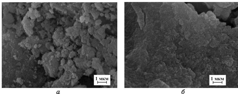
**Рис. 4.** Электронно-микроскопическое изображение поверхности твердеющей композиции на основе 17% геля ГА и порошка ГА/Na-КМЦ, высушенного при 60°С: а — 1% раствор Na-КМЦ; б — 5% раствор Na-КМЦ.
