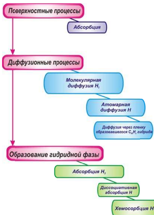
Рис. 10. Гипотетическая модель процессов, протекающих при взаимодействии газообразного водорода с фуллеритом.
