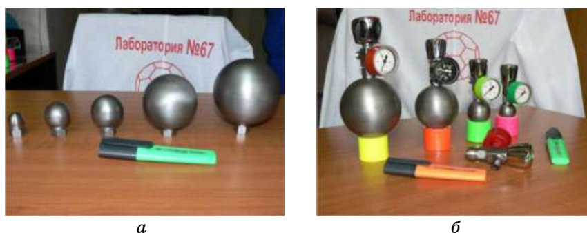
Рис. 3. Сосуды высокого давления для хранения водорода и накопители водорода модификации «Alsav» емкостью 3, 10, 15, 75 и 170 литров.
