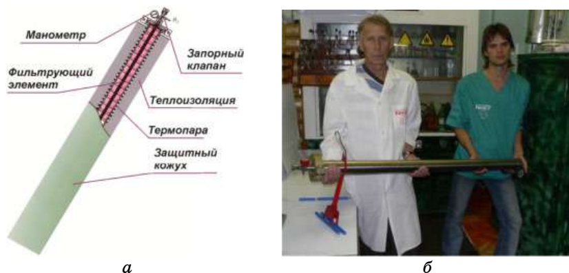
Рис. 2. Нагнетатель высококачественного водорода «SVETZAG-2000».
