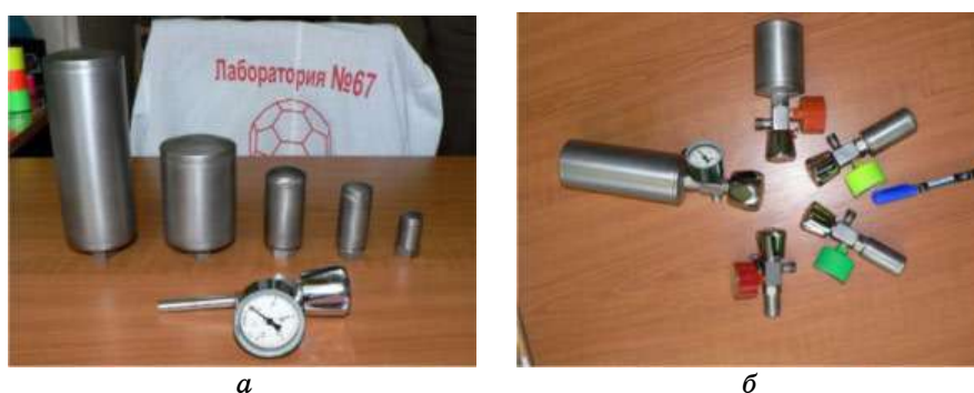
Рис. 4. Сосуды высокого давления для хранения водорода и накопители водорода модификации «Dmisch» емкостью 3, 10, 15, 75 и 170 литров.
