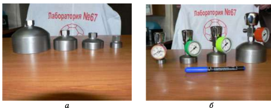
Рис. 5. Сосуды высокого давления для хранения водорода и настольные накопители водорода модификации «Viachbog» емкостью 3, 10, 15 и 75 литров.
