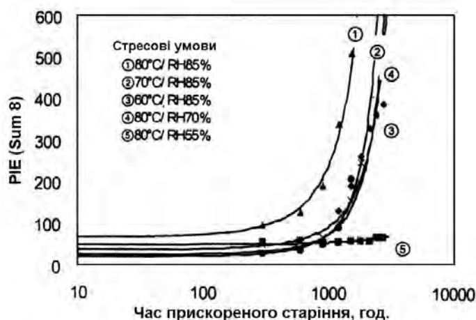
Рис. 3. Збільшення параметра PIE дисків DVD-R у різних стресових умовах прискореного старіння
