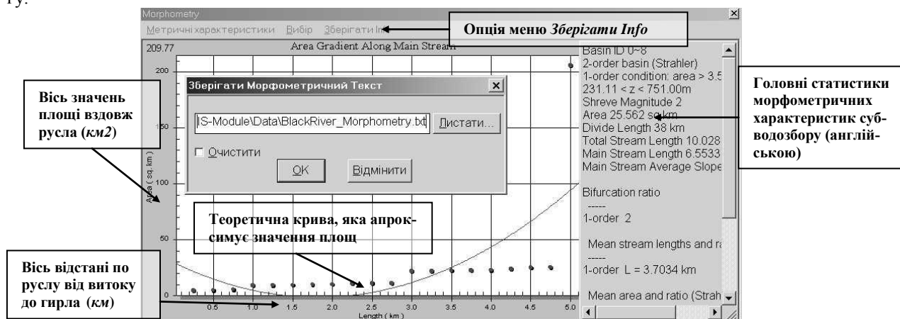
Рис. 6. Графік градієнту площі вздовж русла і діалог Зберегти Морфометричний Текст у вікні Морфометрія .
