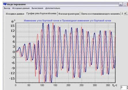
Рисунок 3 – Возникновение значительной амплитуды колебаний при воздействии крупной одиночной волны в составе нерегулярного волнения
