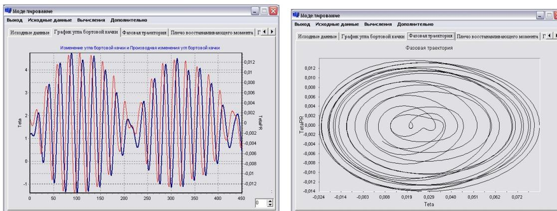
Рисунок 4 – Временные кривые и фазовый портрет колебательных режимов при воздействии пакетов волн
