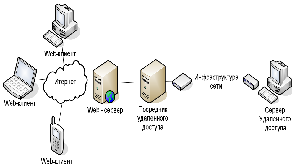
Рисунок 3 – Подключение удаленного управления через Интернет
