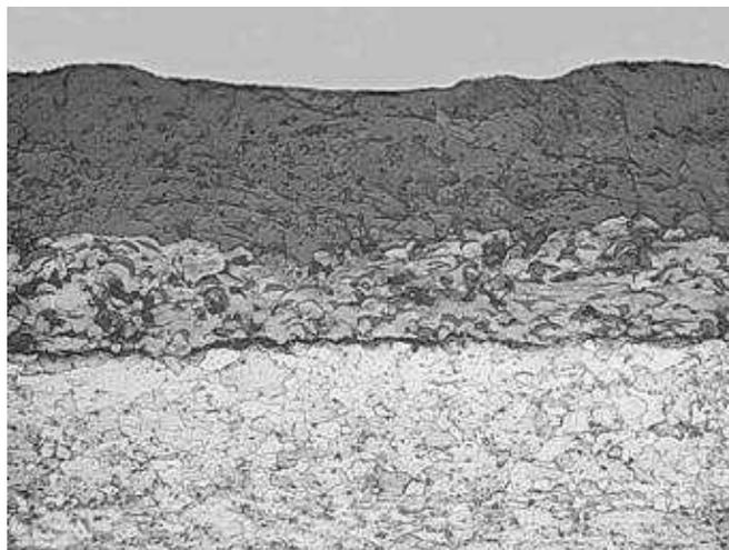
**Рис. 1.** Микроструктура поперечного среза железа с двухслойным композиционным плазменным покрытием из порошков  $NiAl$  и  $Al_2O_3/Ti$  ( $\times 400$ ).
