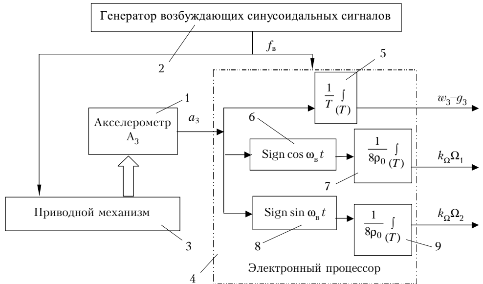
Рис. 2. Функциональная схема инерциального датчика
