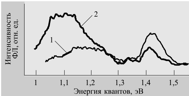
Рис. 6. Спектры ФЛ структур InAs—GaAs, выращенных при 400°С (1) и 500°С (2)
