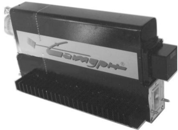
Рис. 2. Опытный образец узкополосного пятирезонаторного полосно-пропускающего фильтра
