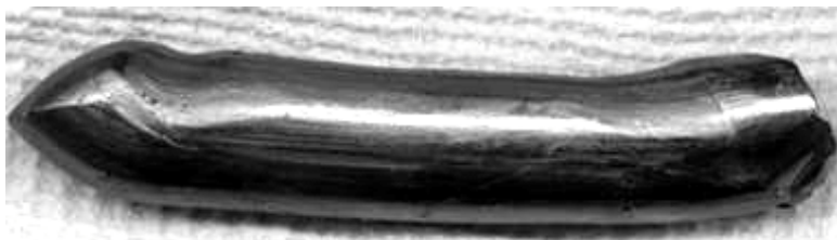
Рис. 1. Образец из сплава Ti_{49.4}Ni_{50.6} после РКУП
