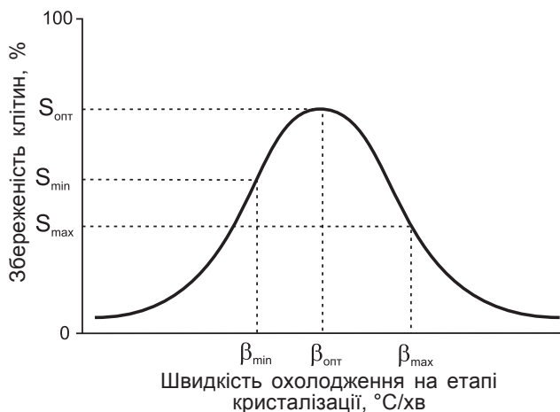
Рис. 1. Типова залежність збереженості клітин від швидкості охолодження на етапі кристалізації [1].
