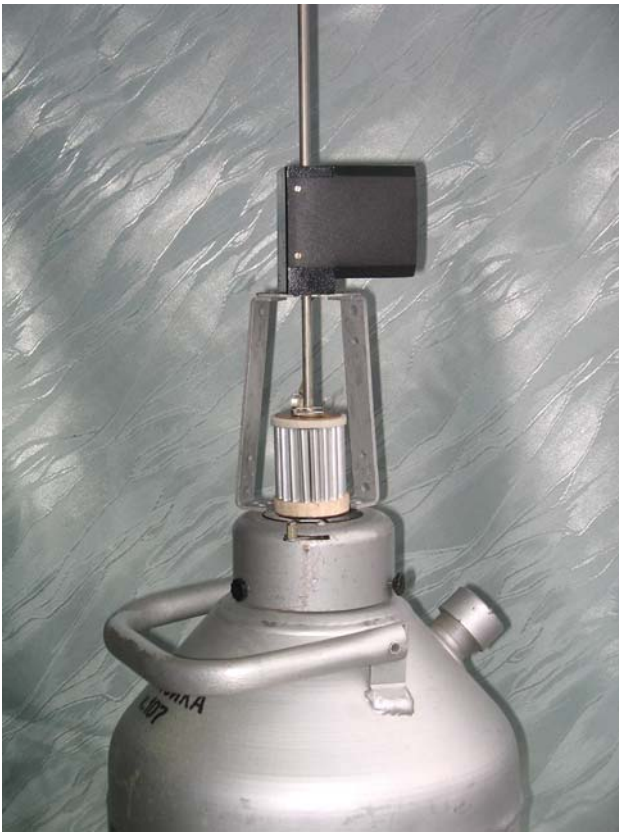
Рис. 4. Зовнішній вигляд пристрою для керованого охолодження контейнерів з біосенсорами на посудині Дьюара.
