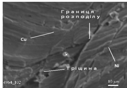
Рис. 4. Розповсюдження тріщини в області межі розділу Cu—Ni після ІГП при температурах 450 (а), 550 (б), 730 (в) та 830 °С (г).
