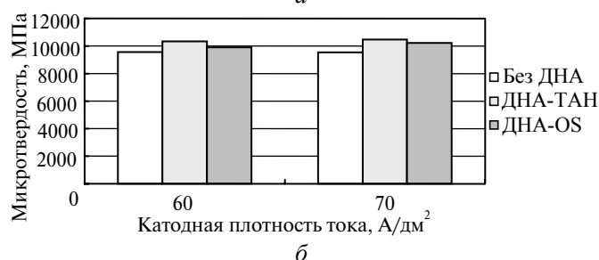
Рис. 5. Микротвердость ХНАП в зависимости от катодной плотности тока и добавки ДНА (5 ( a ), 10 ( б ), 15 ( в ) г/л) различных производителей; режим износостойкого хромирования (см. табл. 3).
