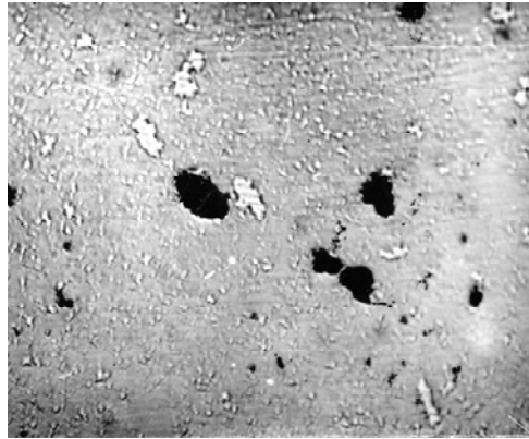
Рис. 1. Мікроструктура спеченого твёрдого сплаву WC—6Ni, \times 100 .
