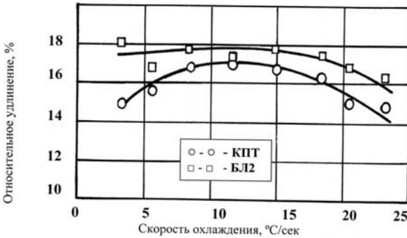
Рис.8. Изменение относительного удлинения сталей КПТ и БЛ2 при увеличении скорости охлаждения от температуры аустенизации (Таустениз.=885°C; \tau=10 мин.; V_{охл.}=4...25^\circ\text{C}/\text{сек} ) после высокого отпуска (Тотпуска=490±5°C; \tau=2.5 час).
