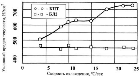
Рис.7. Изменение условного предела текучести сталей КПТ и БЛ2 при увеличении скорости охлаждения от температуры аустенитизации ( T_{\text{аустенитиз.}}=885^{\circ}\text{C} ; \tau=10\text{мин.} ; V_{\text{охл.}}=4\dots 25^{\circ}\text{C/сек} ) после высокого отпуска ( T_{\text{отпуска}}=490\pm 5^{\circ}\text{C} ; \tau=2,5\text{час.} ).
