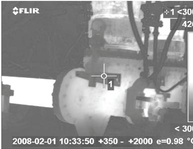
Рис.4. Температурное поле фурменного прибора
