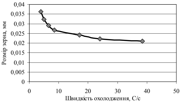
Рис. 7. Залежність розміру зерна мікролегованих ванадієм дослідних зразків від швидкості їх охолодження.
