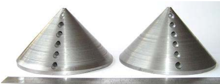
Рис. 1. Модельні зразки «Конус» із мікролегованої сталі з отворами для термопар.
