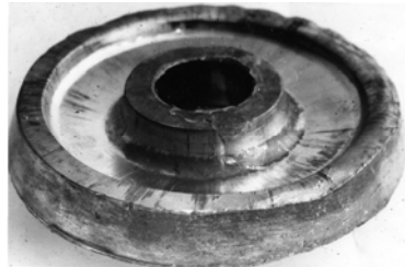
Рис.2. Вид свинцовых заготовок, отформованных на прессе усилием 2,5 МН.
