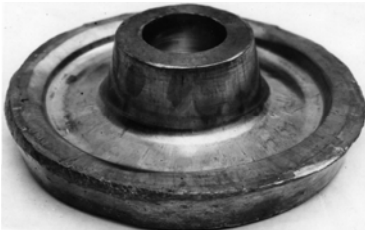
Рис.2. Вид свинцовых заготовок, отформованных на прессе усилием 2,5 МН.
