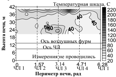
Рис. 11. Термограмма развертки кожуха ДП № 9 АМКР по данным АСУ
