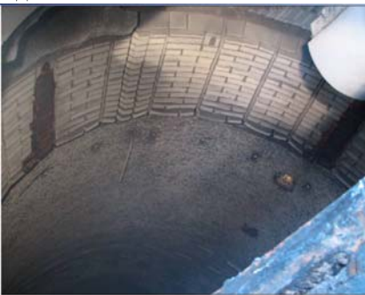
Рис. 19. Фотографии рабочего пространства печи после ее выдувки
