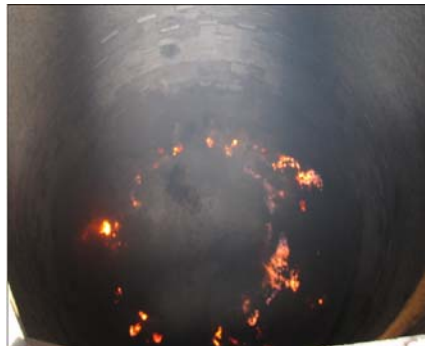
Рис. 19. Фотографии рабочего пространства печи после ее выдувки
