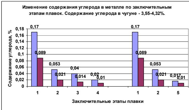
Рис.1. Изменение содержания углерода в металле по заключительным этапам плавки. Содержание углерода в чугуна – 3,55–4,32%.
