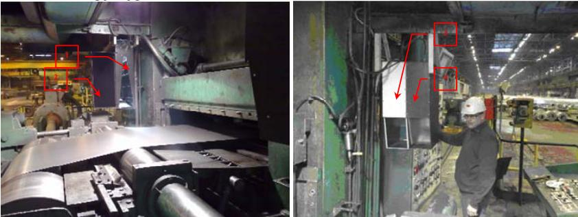
Рис. 3 Выходная сторона дрессировочного стана с осветителем (1) и экраном тепловизора (2) со стороны привода, а также боксы телевизионной (3) и тепловизионной (4) камер электронно-оптической системы измерения плоскостности и температуры полосы со стороны обслуживания
