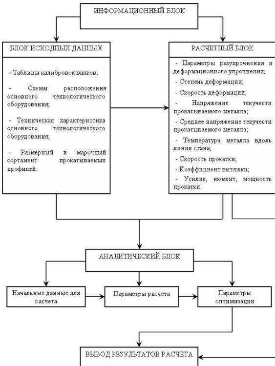
Рис.1. Структурная схема разработанной информационно–аналитической системы непрерывной сортовой прокатки
