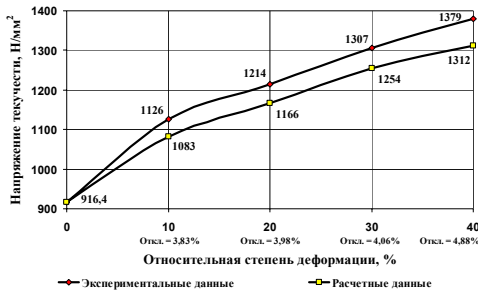
Рис.5. Результаты проверки адекватности выбранной модели процесса плющения прокаткой–волочением, адаптированной к условиям прокатной лаборатории ИЧМ: а – Сравнение фактической и расчетной формы поперечного сечения ленты; б – Изменение предела текучести металла при проведении экспериментальных и численных исследований.
