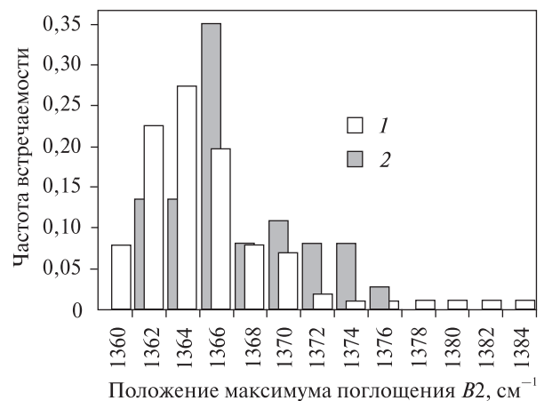
Рис. 5. Частота встречаемости положений ( \text{см}^{-1} ) максимума ИК-поглощения на дефектах B2 в бразильских алмазах: 1 — бассейн р. Макаубас; 2 — район Жуина
