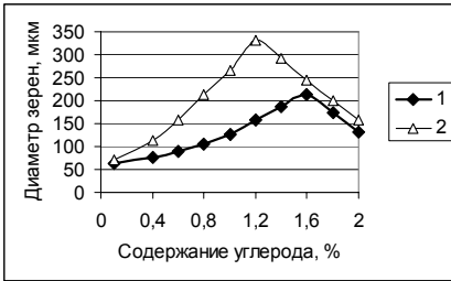
Рис.2. Влияние содержания углерода на размер зерен аустенита при нагреве [6]. Температура нагрева 1100 (1) и 1200 0 С (2).
