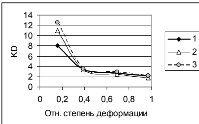
Рис. 5. Влияние степени деформации на соотношение диаметров исходных и деформированных зерен аустенита. Размер исходных зерен 100 (1), 200 (2) и 300 мкм (3). Экспериментальные данные [7].
