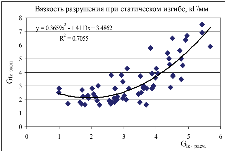
Рис. 4. Соотношение рассчитанных по уравнению (3) вязкости разрушения и ее экспериментальных значений
