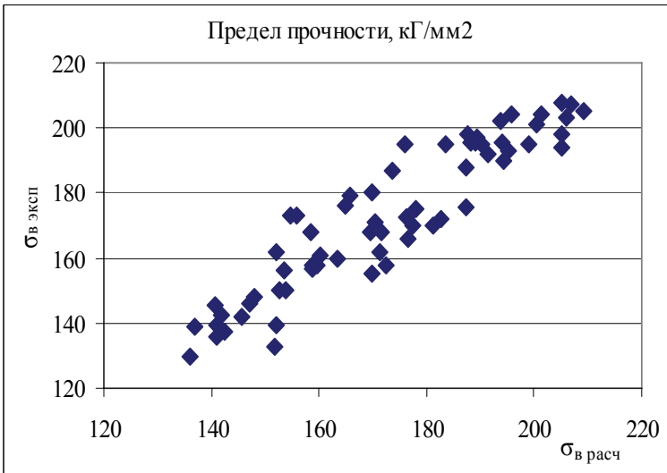
Рис. 2. Соотношение рассчитанных по уравнению (2) и экспериментальных значений предела прочности
