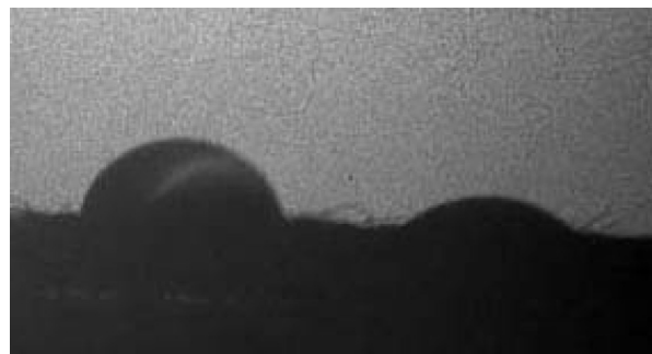
Рис. 11. Крапля води (ліворуч) і водного розчину суспензії срібла з ПАВ (праворуч) на внутрішній поверхні нетканого матеріалу через 30 с після нанесення
