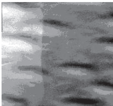
Рис. 2. Электронно-микроскопический снимок пленки \text{Ni}/\text{Y}_2\text{O}_3 , подвешенной на сеточке, \times 48000 . Угол падения электронного луча к плоскости пленки равен 45^\circ
