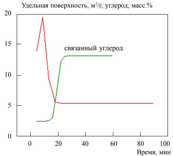
Рис. 2. Развитие удельной поверхности и изменение концентрации связанного углерода в системе Cr—C при размоле в планетарной мельнице
