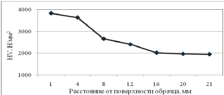
Рис.2. Изменение фазового состава слоя (а) и аддитивной твёрдости (б) по сечению закаленного слоя образца штампа из стали 20ХФ.
