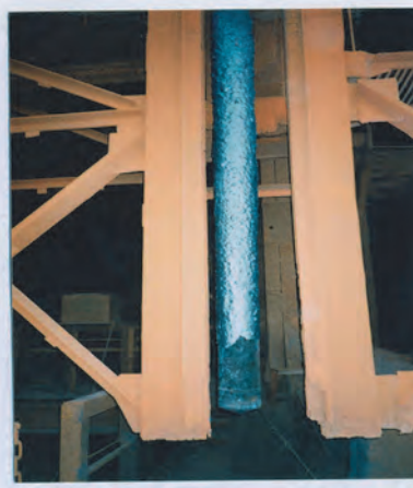
В – Вид фурмы при работе опытной системы наложения низковольтных потенциалов на плавке № 234799 (конец 4-й плавки после обрезки настывли)
