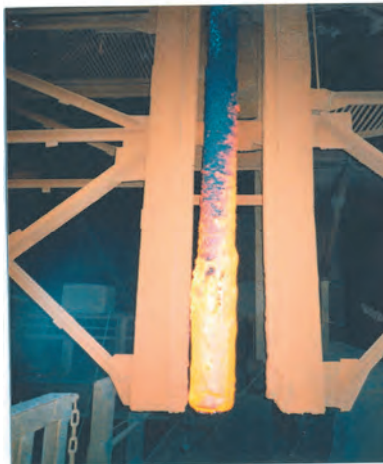
А – Вид фурмы перед плавкой № 234836 с электрическими воздействиями (5-я плавка после обрезки настыли)
