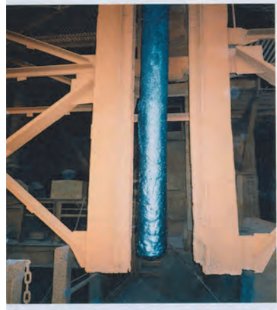
Г – Вид фурмы после плавки № 234800 с электрическими воздействиями (конец 5-й плавки после обрезки настывли)
