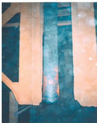
Г – Вид фурмы на плавке № 234836 с электрическими воздействиями после дудовки плавки
