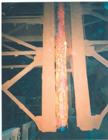
Б – Вид фурмы во время плавки № 234836 после ошлакования футеровки азотом во время скачивания шлака (9-я минута продувки).
