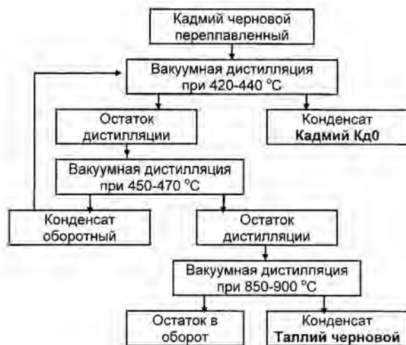
Рис.6. Схема переработки вакуумной дистилляцией черного переплавленного кадмия с высоким содержанием таллия.
