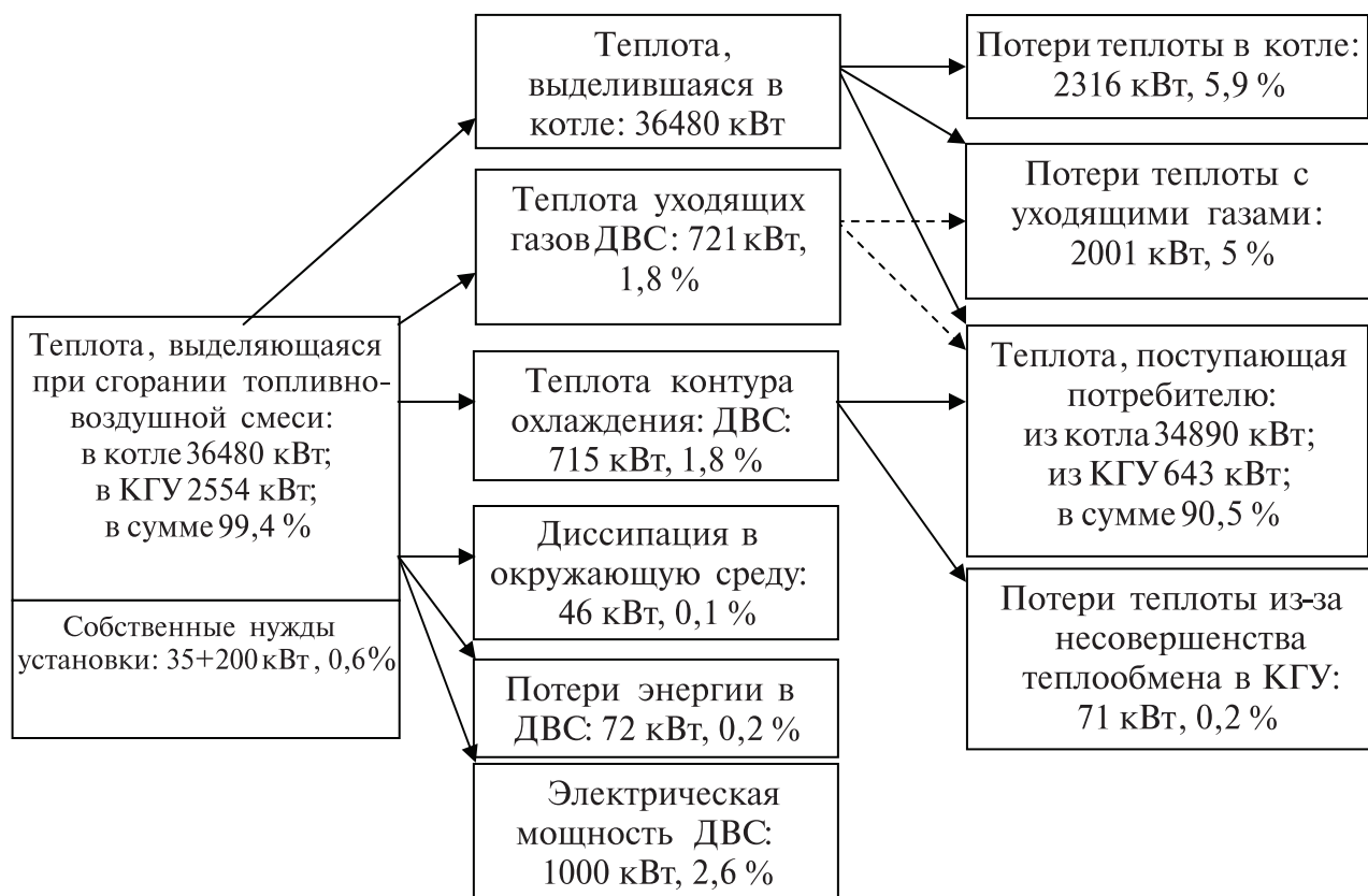
Рис. 3. Тепловой баланс когенерационной схемы на базе ДВС и ВК.
