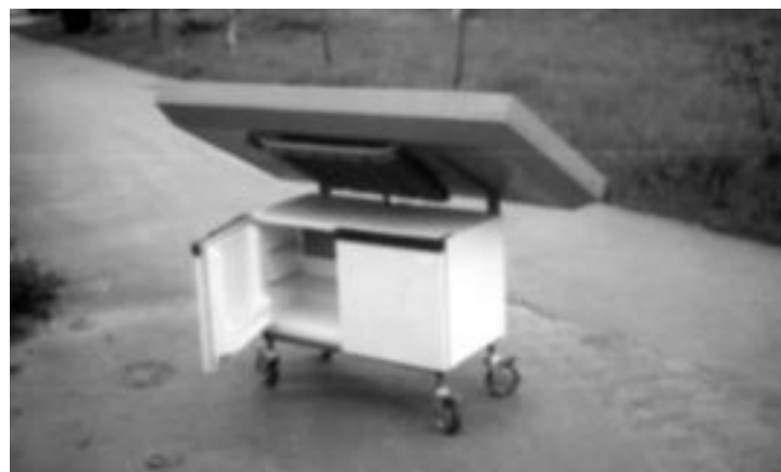
Рис. 4. Экспериментальный солнечный адсорбционный холодильник.
