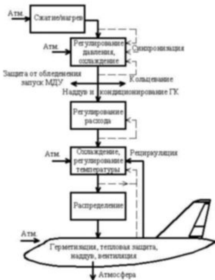
Рис. 1. Схема кондиционирования воздуха в ГК самолета.
