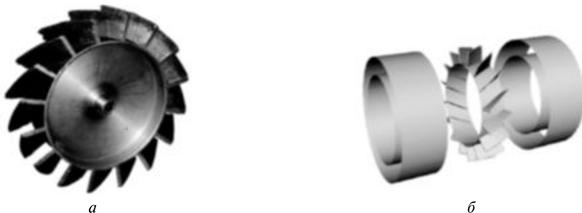
Рис. 1. Внешний вид турбинки расходомера газа (а) и геометрической части CFD-модели с входным и выходным каналами и лопатками турбинки (б).
