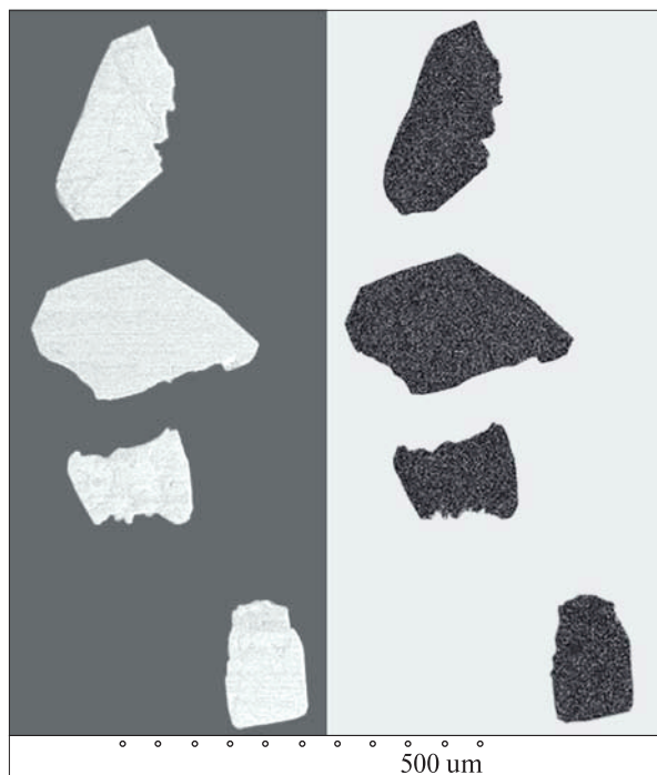
Рис. 6. Зображення цирконів, виділених з пр. 268 (Прутівський масив) у відбитих електронах (ліворуч) та катодних променях (праворуч)
