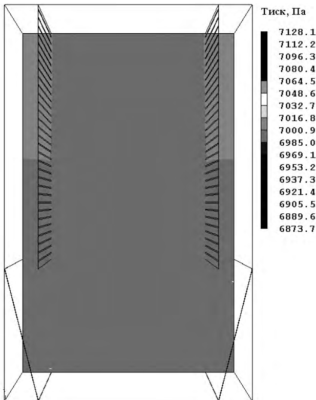
Рис. 13. Розподіл тиску у змінній (модернізованій) робочій області печі. Швидкість потоку з вентилятора – 8 м/с, Y \approx 450 мм
