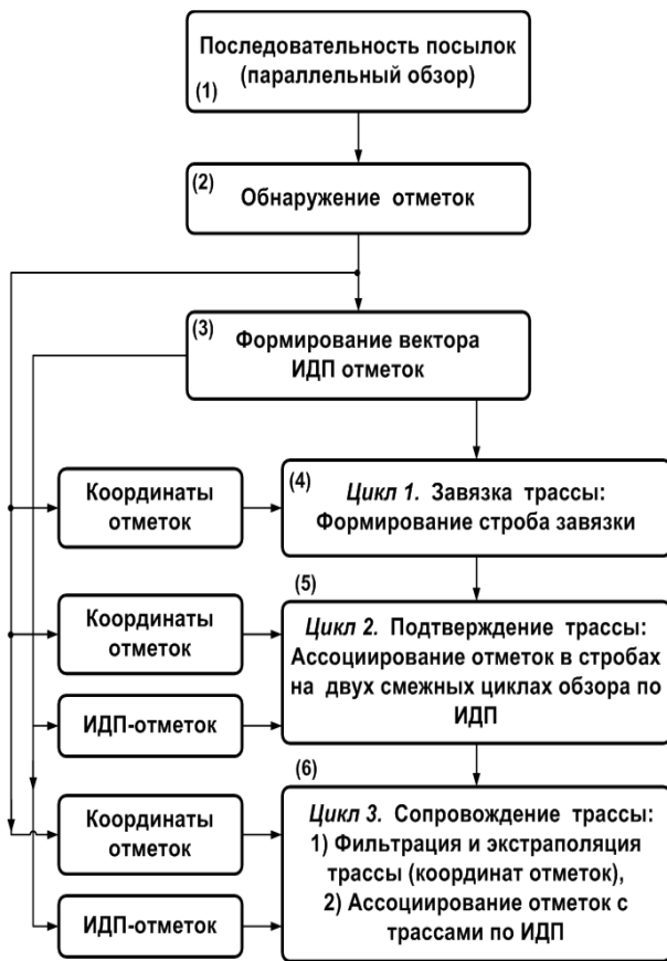
Рис. 6 - Фрагмент алгоритма вторичної обробки ГЛ-інформації (зав'язка, підтвердження і супроводження отміток)
