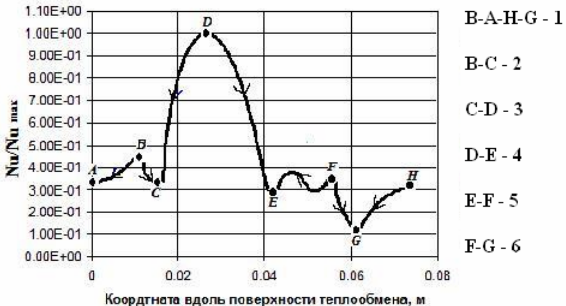
Рис. 3. Распределение величины Nu/Nu_{max} при Re = 10^4 вдоль теплообменной поверхности периодического модуля.
