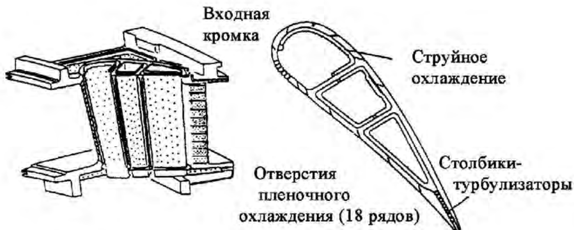
Рис. 5. Схема охлаждения СЛ первой ступени двигателя М701Г1.
