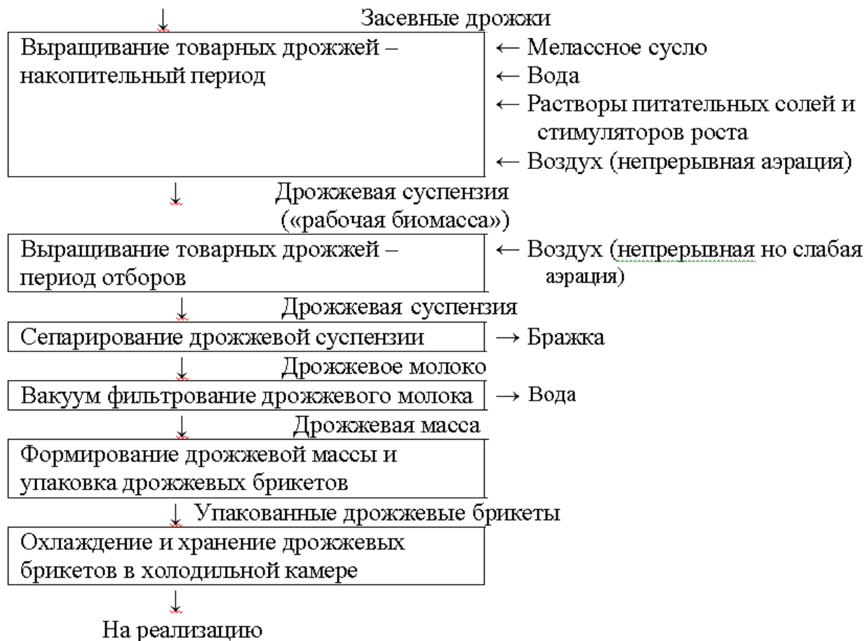
Рис. 1. Принципиальная технологическая схема выращивания и выделения товарных дрожжей с последующей их обработкой.
