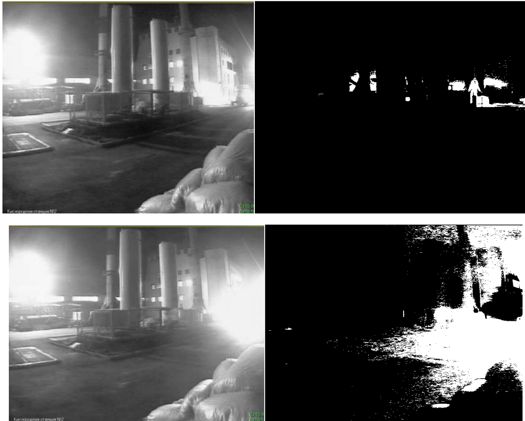
Рисунок 3 – Робота алгоритму в умовах швидкої зміни освітлення
