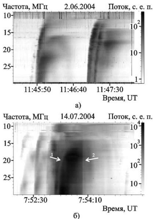
Рис. 6. Необычные U-всплески: а) – расщепленный U-всплеск, б) – U-всплеск с “вложенными арками”
